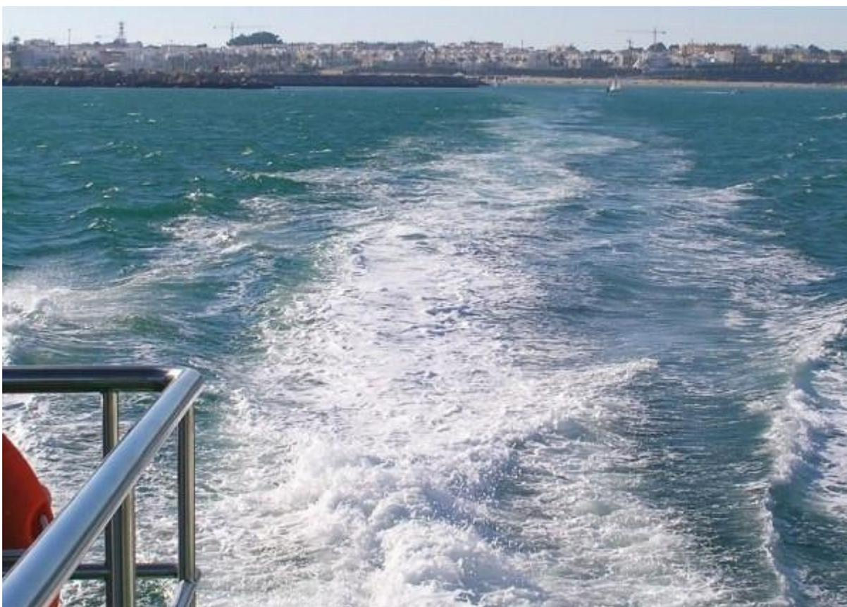
出港して防波堤をかわすと一気にトップ・スピードです。FRP(強化プラスチック)の軽い船体と、カタマランの特徴である造波抵抗の小ささでトップ・スピードに達するのもアツという間。高速のわりに大きな引き波が出ないのもそのためです。
