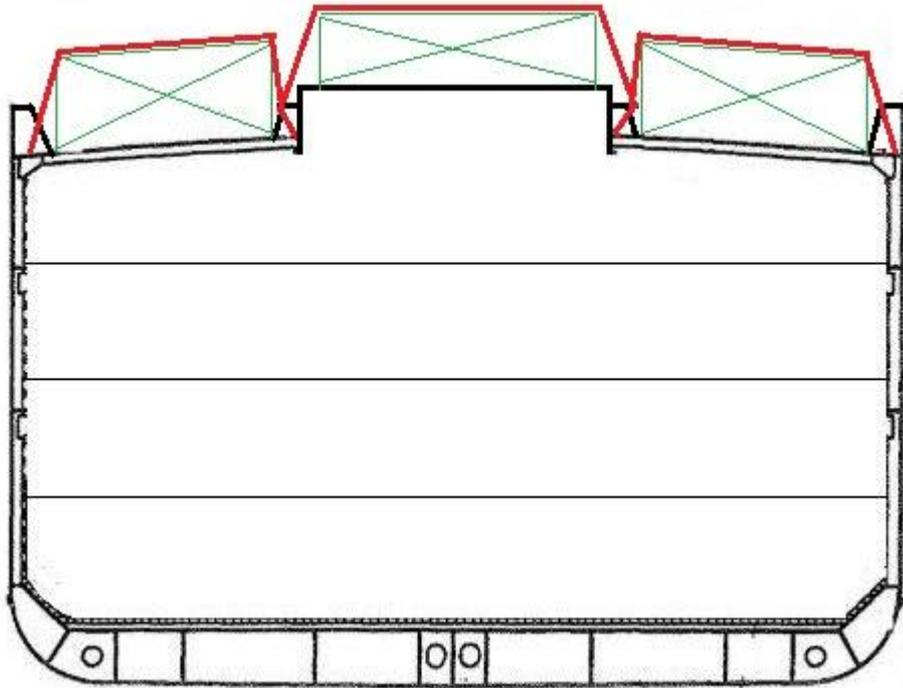
デッキ上の製材の高さは 2m、ハッチ上は 1.5m 以下に収める。ラッシングは赤線のようにワイヤーでのみ小さくまとめて行う、ラッシング・ワイヤーを止めるデッキ・アイのない所では下図の赤矢印で示したブルワーク・ステイ bulwark stay とハッチ・コーミング・ステイ hatch coaming stay の根元の開口を利用することにしました。次の図はデッキ部分の横断面で、Konvall とは細部のサイズは違いますが、構造は大体似たようなもの。
