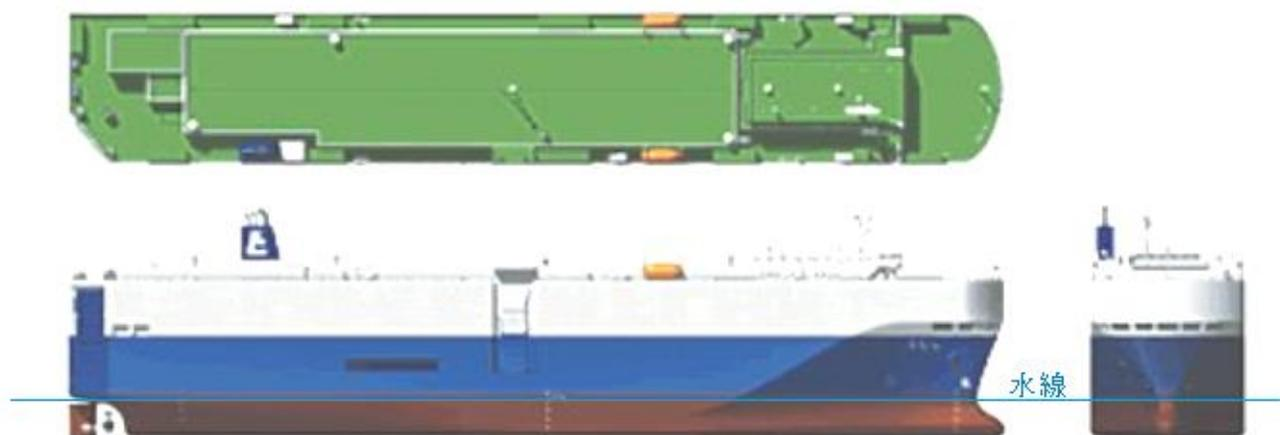
赤色の水線下の船体側面積に対してブルー＋白色の水線上側面積は3倍以上。上の図で
