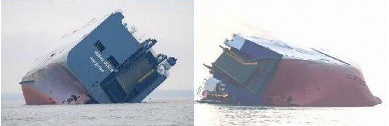
H.O.号は左転しようとして右舷に転覆。 G.R.号は右転しようとして左舷に転覆。 いずれの事故も時化の影響は考えられない水域での事故です。 左転して右に転覆、右転して左に転覆、方向は正反対ですが、船体傾斜が遠心力によることは共通且つ明白です。
