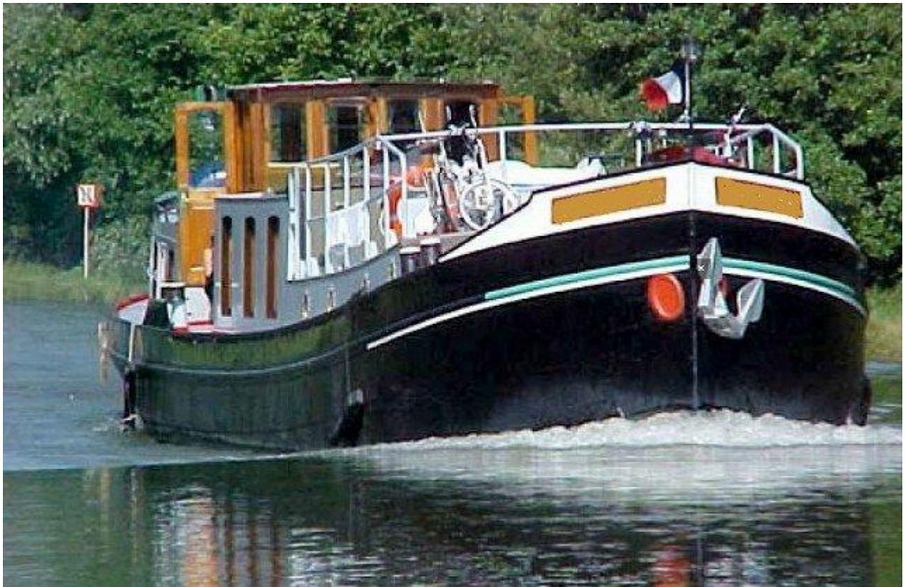
このボートのスタイルはオランダの運河を走る船が原形で、こんなデザインのボートをダッチ・バージ Dutch Barge と呼びます。全長 15m ほど、ロックや橋の通航制限があるため幅は 4m $\sim$  $\alpha$ 、操舵室の屋根は取り外し可能で水面上高さは 2m $\sim$  $\alpha$  程。
