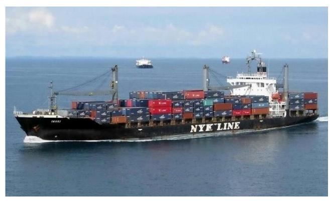
Iwaki の稿で記したように、この船の就航航路は南米西岸専門でした。 当時、この航路では近代的港湾施設が整備されていない港、即ちコンテナー船としては稀な「本船クレーンでの荷役」をする港が多かった、だから、クレーンの装備が必須だったのです。
